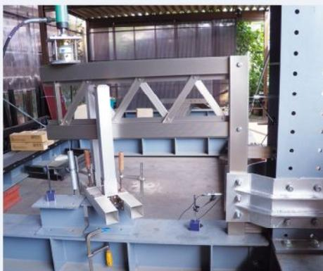
柱：梁接合部強度試験の様子
