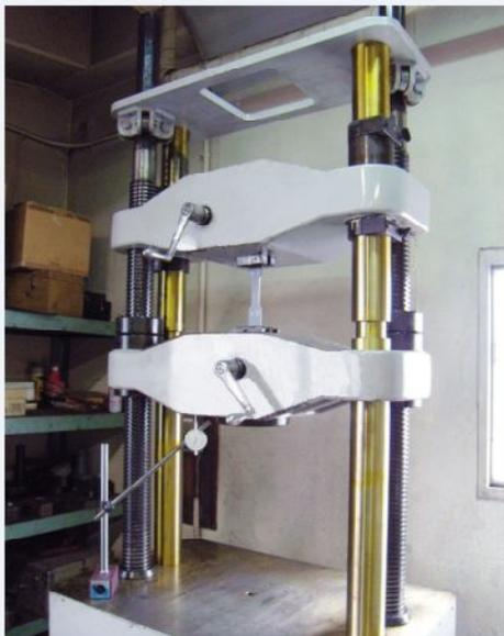
材料引張り強度試験の様子
