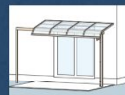
補強梁持出し
