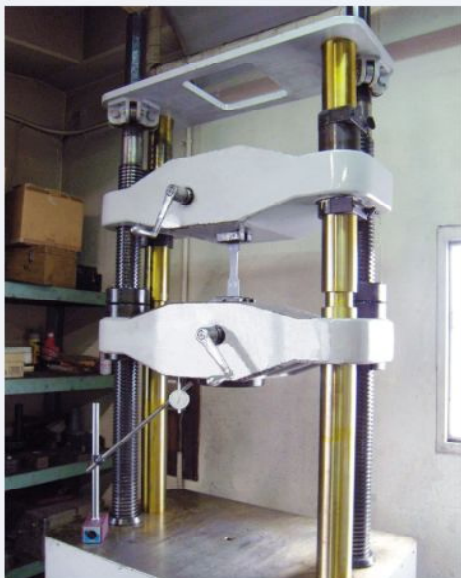
材料引張り強度試験の様子
