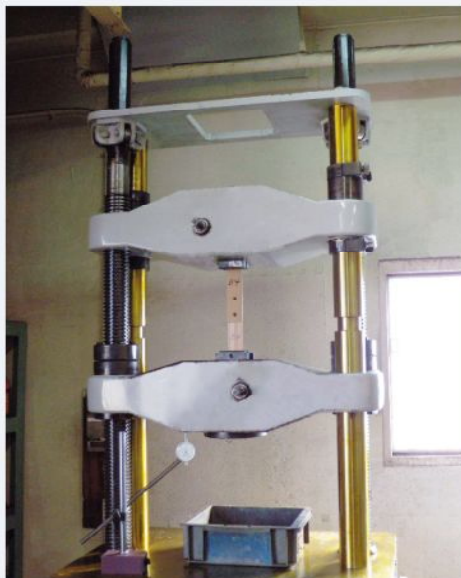
ねじせん断強度試験の様子
