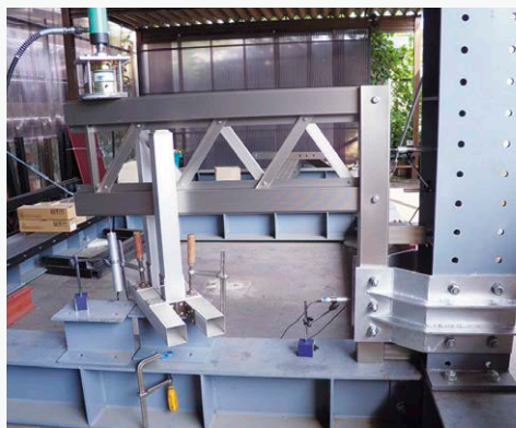
柱：梁接合部強度試験の様子
