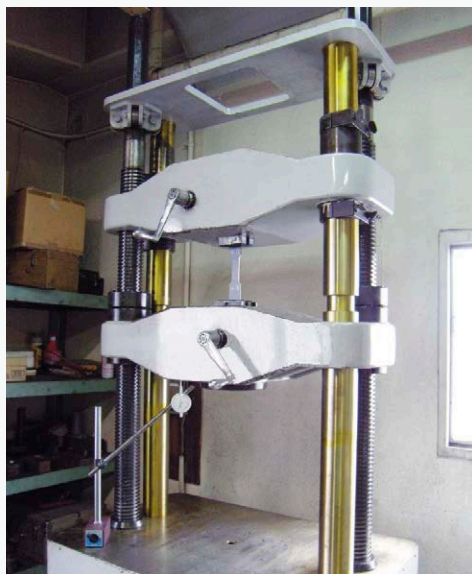
材料引張り強度試験の様子
